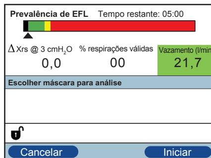
7. Selecione a tecla Direita (Iniciar) para iniciar a Análise do ExpiraFlow. O processo de análise começará em 3 cm H<sub>2</sub>O com a FOT (Técnica de oscilação forçada) a 5 Hz com uma amplitude de 2 cm H<sub>2</sub>O.
