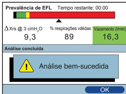
Se o processo de análise falhar, a tela de confirmação indicará o motivo da falha. Selecione a tecla Direita (OK) para aceitar a tela de confirmação. O ventilador retornará à tela Em espera.
